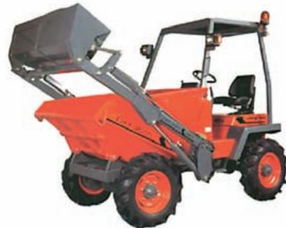
Figura 7. Dúmper de obra con capacidad de auto-carga.
