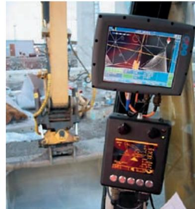
Figura 9. Avanzado sistema de control de máquina excavadora, llamado GEOROG [42].
