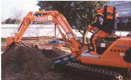
Figura 6: Robot humanoide conduciendo una pala excavadora.
