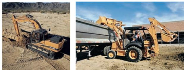
Figura 1: Ejemplos de excavadora hidráulica (izda.) y retropala (dcha.)
