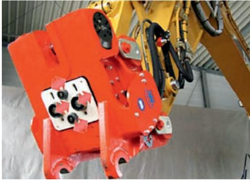
Figura 3. Sistema hidráulico de adaptación rápida de herramientas [12].
