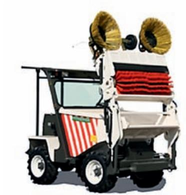
Figura 9. Dúmper barreadora con posibilidad de cambio por pala cargadora.
