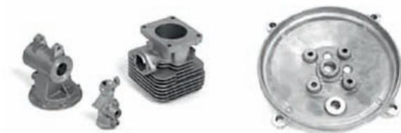
Figura 1. Piezas de aluminio fabricadas por die casting.
