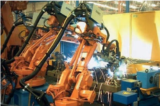
Figura 1. Estación robotizada de soldadura. (Fuente: Sunarc)
