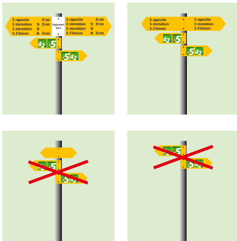
Fig. 18 Conseils de montage pour les indicateurs de direction avec champs d'itinéraire.
