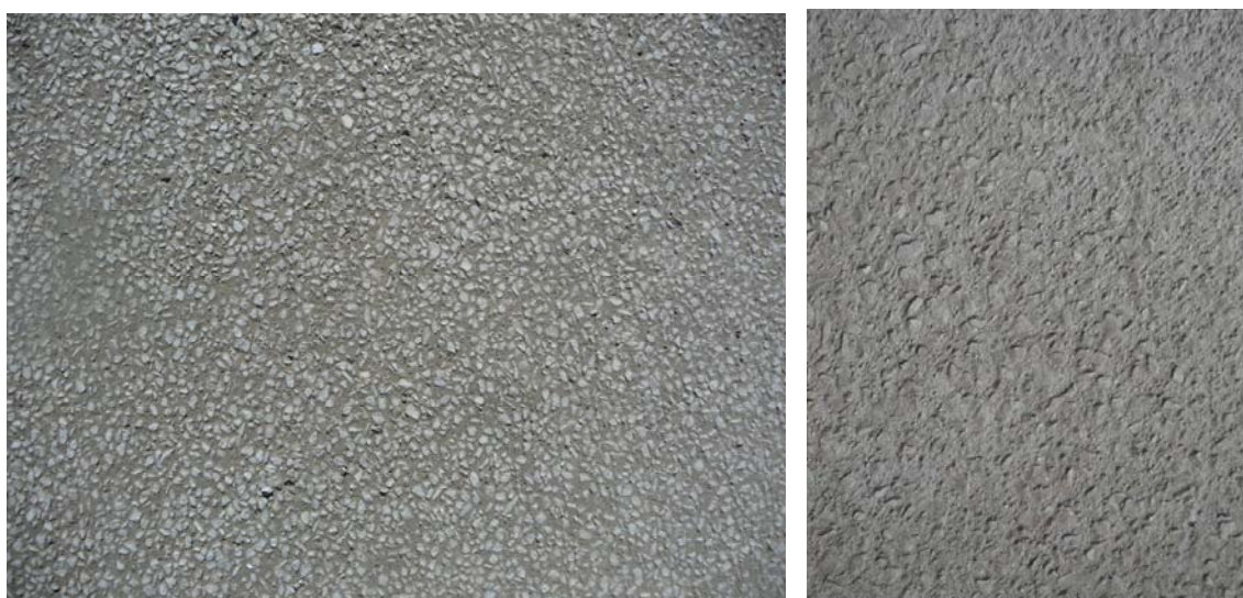
Figura 6.3.- Textura capa rodadura: a) inicial o de proyecto y b) prueba en HAC
