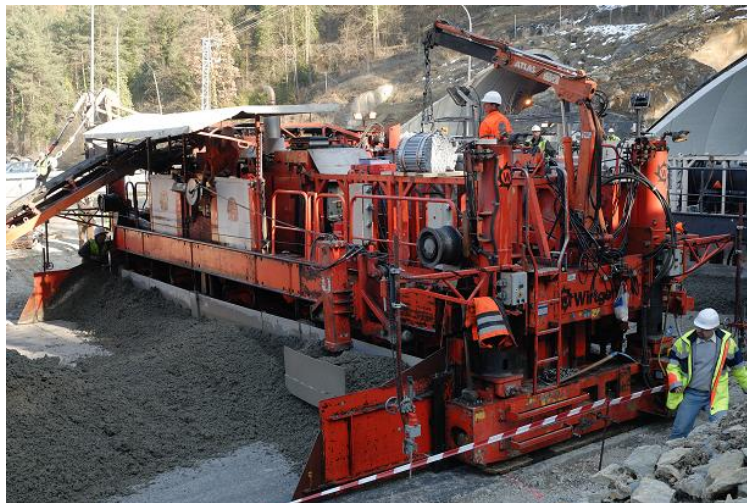
Figura 3.3.- Parte anterior de la extendedora de la capa de base
