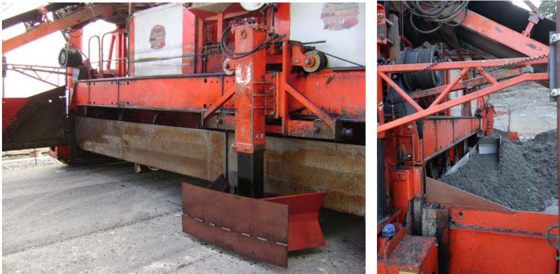
Figura 8.10.- Cuchilla extendidora: a) antes del extendido y b) durante el extendido
