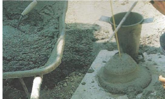
Figura 9. Medida de la consistencia de un mortero ligero con cono de Abrams
