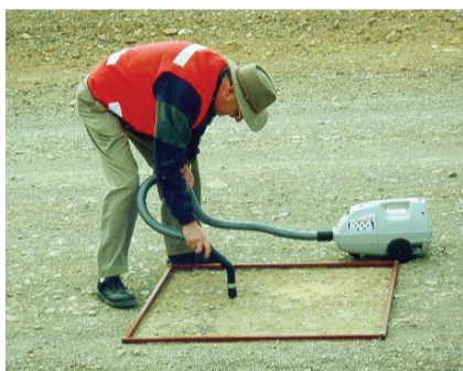
Technique de mesure des quantités de poussières sur les routes australiennes en terre
