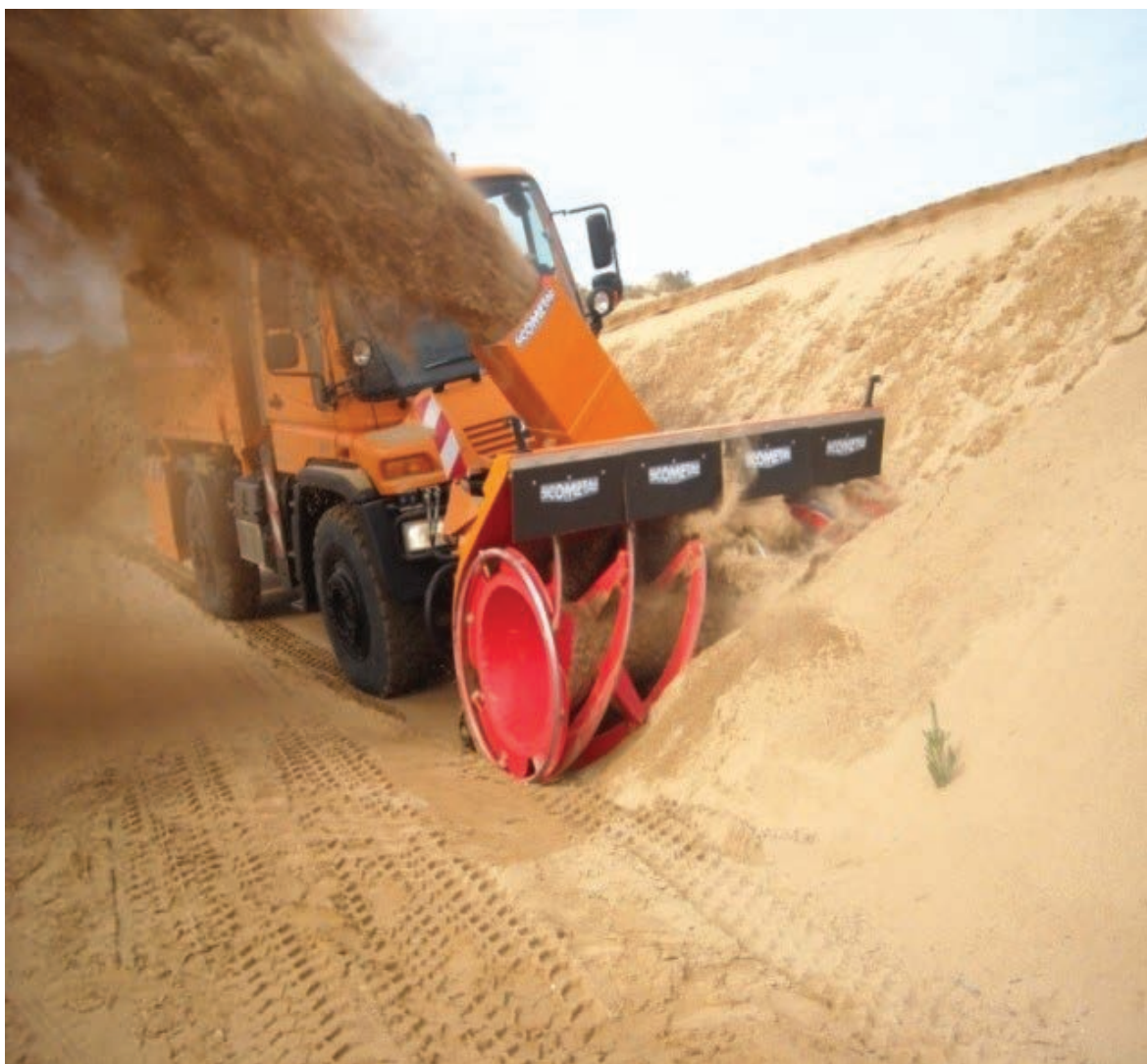
Technique de désensablage sur route au Sud du Maroc (Laayoune): turbo fraise à sable
