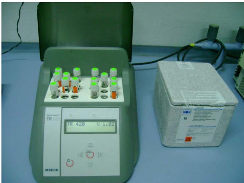
Figura 71: Digestor Merck utilizado para los testes en cubetas de nitrógeno total
