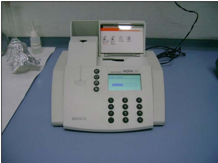
Figura 72: Espectrofotómetro Merck utilizado para los testes en cubetas
