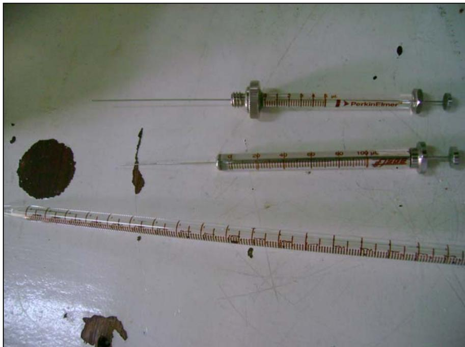
*Figura 75: Jeringas y pipeta, utilizadas para los reactivos*
