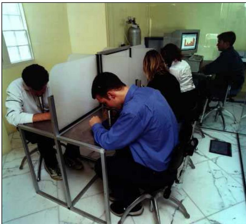
*Figura 4: Olfatometría Dinámica con asesores humanos, para medir la concentración del olor según EN13725. Foto por cortesía de Odournet UK Ltd.*
