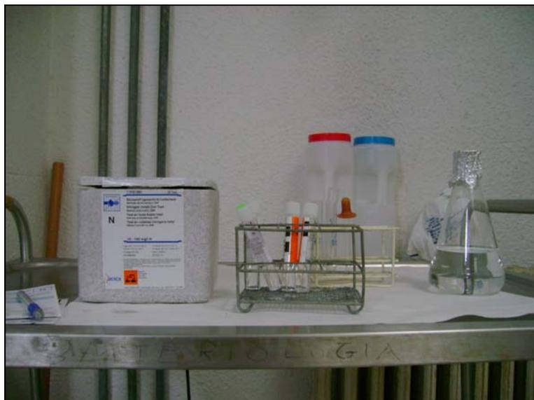
Figura 73: Kit Merck de test en cubetas de nitrógeno total
