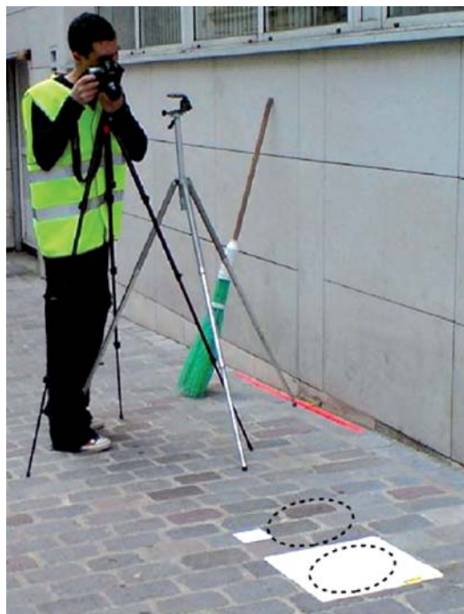
Protocole expérimental permettant d'évaluer le contraste des bandes d'éveil de vigilance avec leur environnement immédiat
