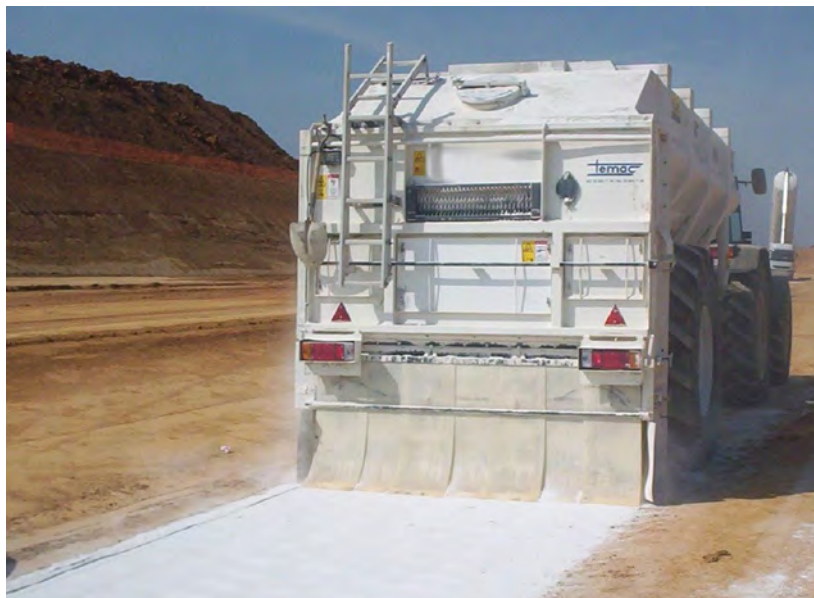
Foto 6: Distribuidor de polvo cerrado con dosificación proporcional a la velocidad
