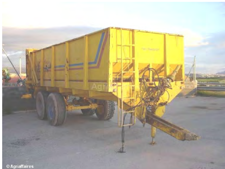
Foto 7: Distribuidor de polvo abierto sin dosificación proporcional a la velocidad
