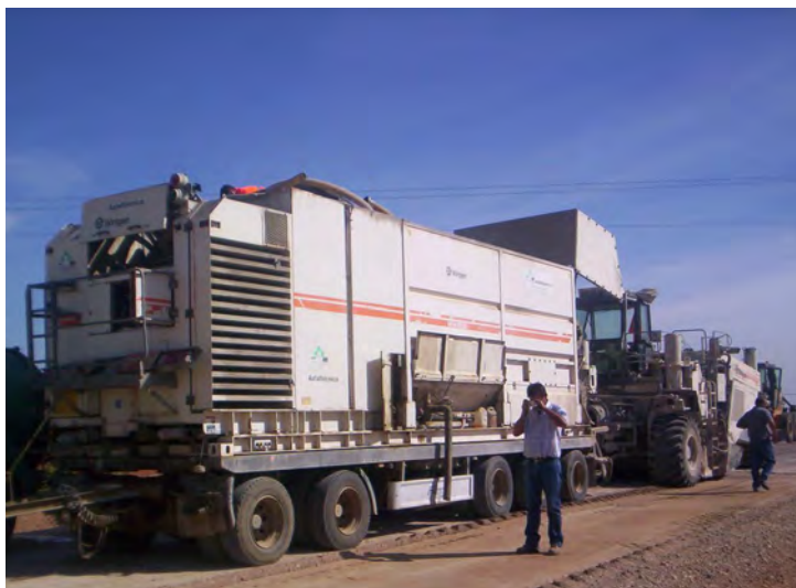
Foto 9: Dosificador de lechada acoplado a estabilizadora
