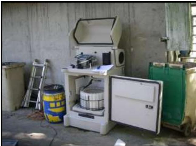
Figura 14.- SIGMA SD900 (Afluente)
