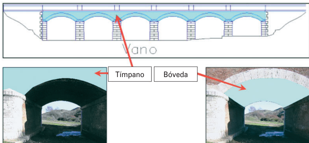
FIGURAS 7, 8 Y 9. ELEMENTOS DE UNA BÓVEDA
