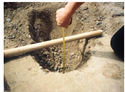
Fotos 13 y 14. Suelos muy finos, sin estructura granular, no aconsejables para realizar suelocemento
