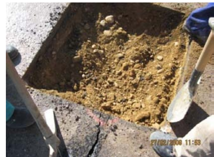
Fotos 19 y 20. Fisuras aparecidas por fallo de algún inyector y calicata de comprobación
