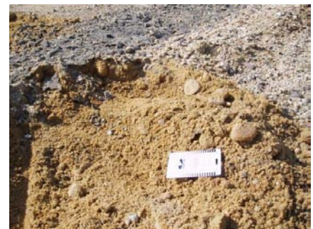
Fotos 13 y 14. Suelos muy finos, sin estructura granular, no aconsejables para realizar suelocemento
