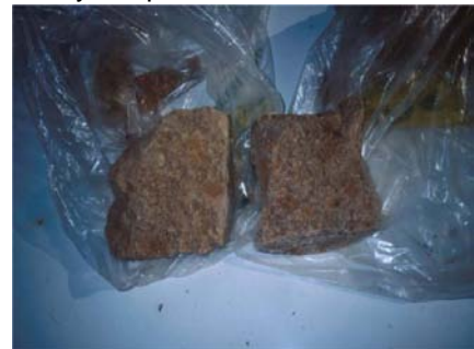
Foto 17. Probeta de suelocemento con terrones de partículas plásticas no disgregadas
