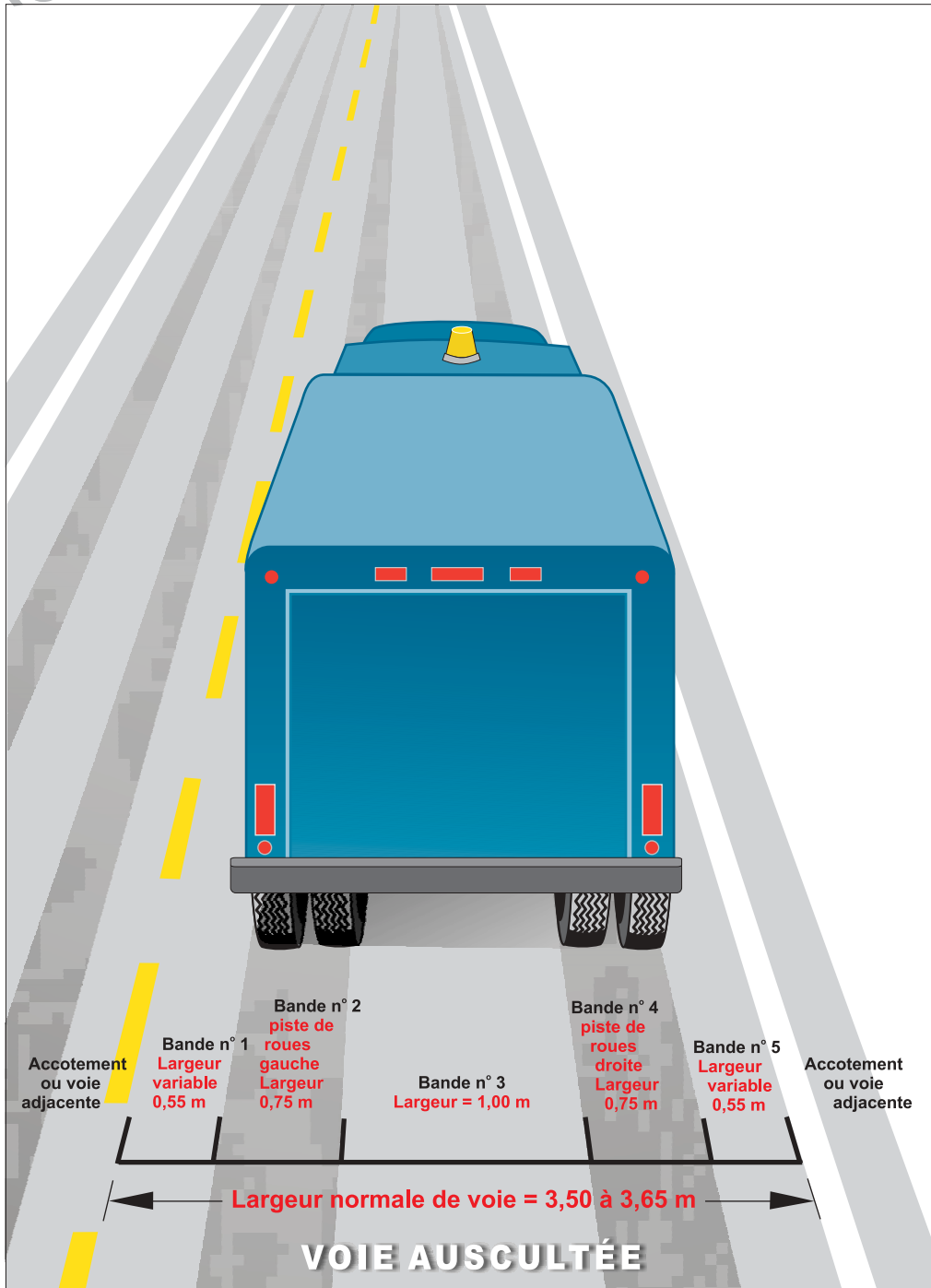
Figure 1-1 Détails des bandes d'auscultation pour la fissuration
