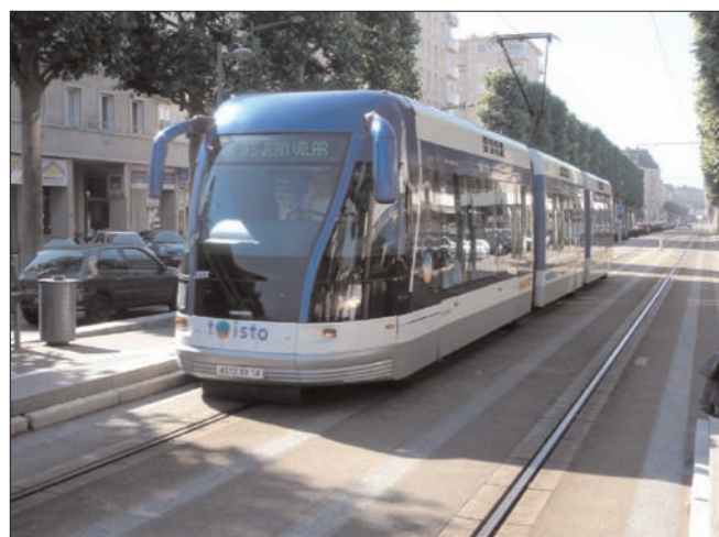
Figuras 5, 6 y 7- Plataforma reservada en Caen. La tracción es eléctrica y el guiado por monorraíl.
