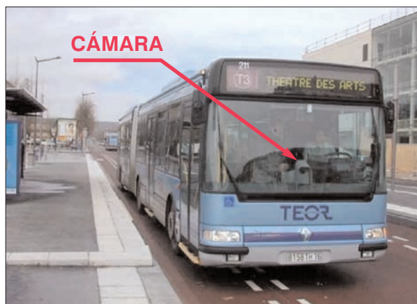
Figura 4 - Plataforma reservada en Rouen (Teor BRT). La tracción es diesel y dispone de guiado óptico.
