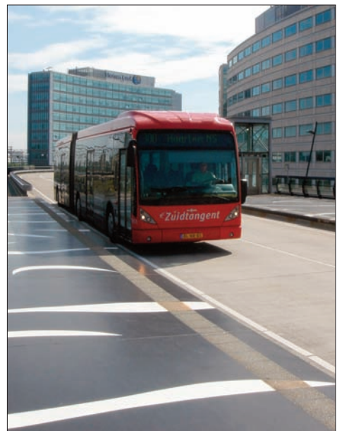
Figuras 8 y 9 - Plataforma reservada en Amsterdam (Zuidtangent). La tracción es diésel y no dispone de guiado
