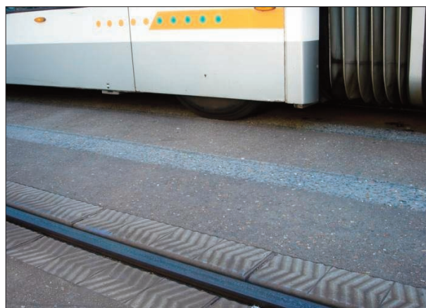
Figura 3 - Plataforma reservada en Castellón. La tracción es eléctrica y dispone de guiado óptico.
