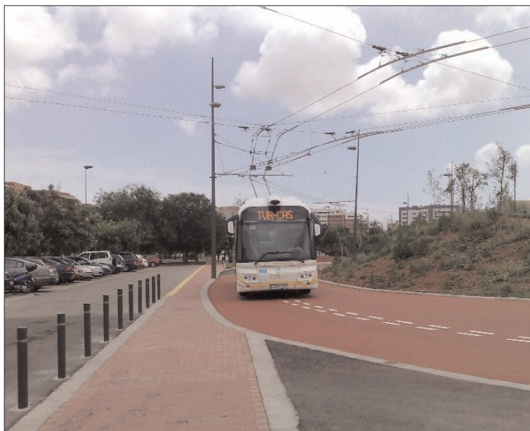
Figuras 10 y 11 - Plataforma reservada en Castellón (TVRCAS). Los vehículos son híbridos. Detalle de la catenaria.
