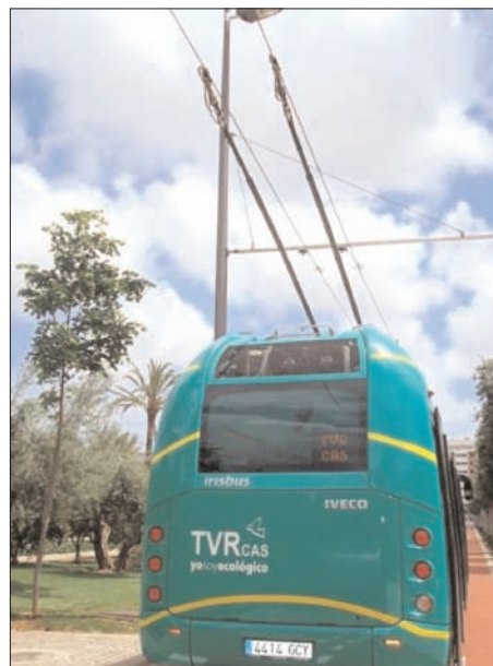
Figuras 10 y 11 - Plataforma reservada en Castellón (TVRCAS). Los vehículos son híbridos. Detalle de la catenaria.
