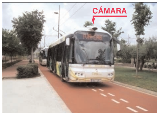
Figura 3 - Plataforma reservada en Castellón. La tracción es eléctrica y dispone de guiado óptico.
