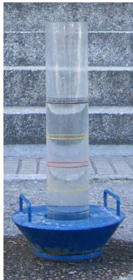
Figura III-15. Permeámetro del LCS (Laboratorio de Caminos de Santander).
