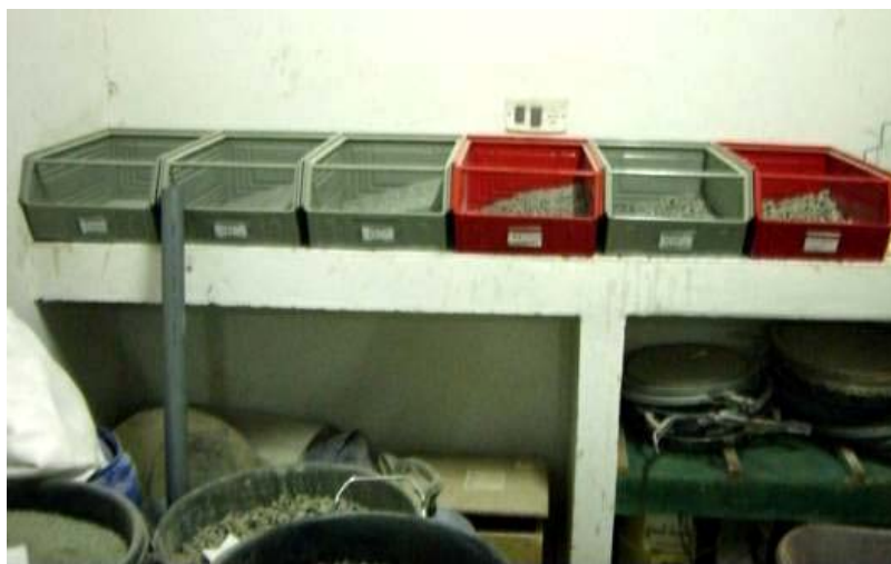
Figura III-21. Almacenamiento de los áridos ofíticos empleados para la fabricación de mezcla bituminosa porosa en seis fracciones de tamaños: 20/12,5; 12,5/8; 8/4; 4/2; 2/0,5 y 0,5/0,063 mm.
