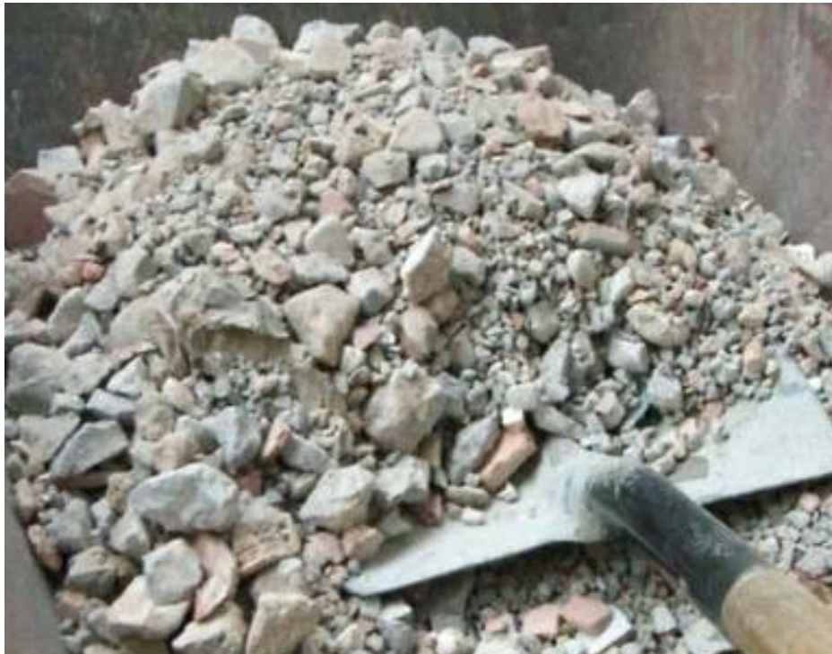
Zahorra drenante de árido reciclado procedente de la planta de BTB.
