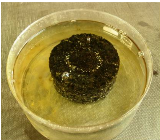
Figura III-27. Ensayo de inmersión completa de probetas de mezcla bituminosa porosa en agua con hidrocarburos.
