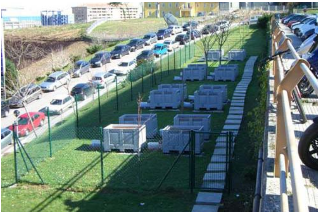
Figura III-39. Modelos de firmes permeables del Campus de la Universidad de Cantabria, Santander.
