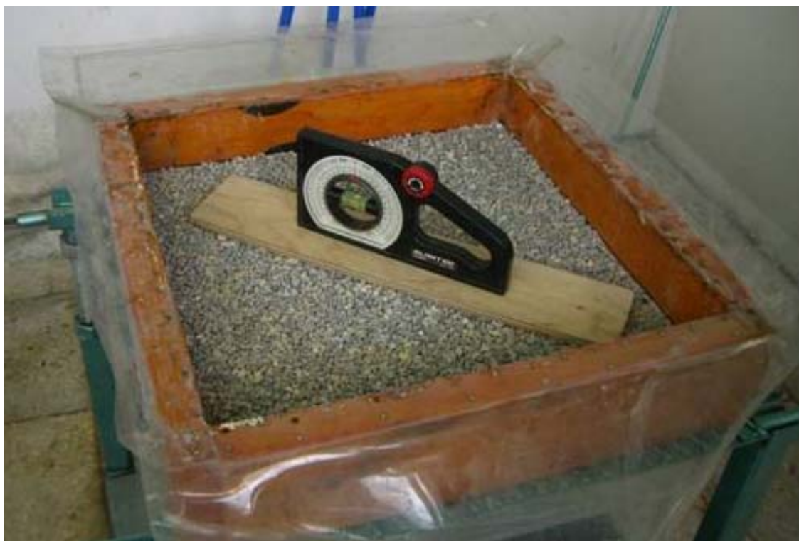
Figura III-4. Construcción de la muestra de pavimento permeable para ensayar en el ICF: colocación de la base granular nivelada.
