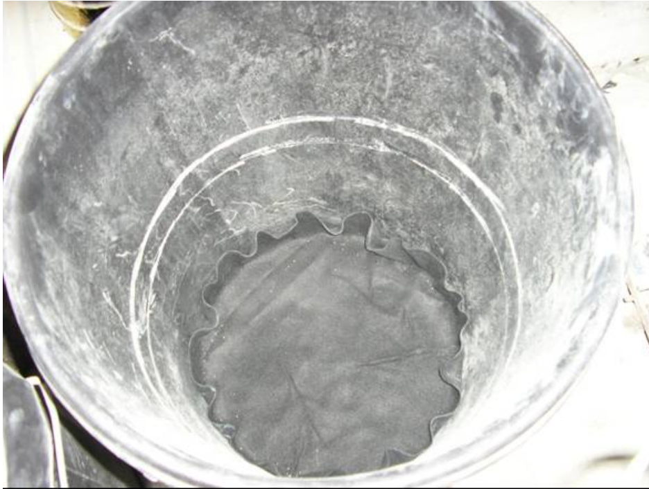
Celda y geotextil de fondo en los cubos del Laboratorio FIDICA.
