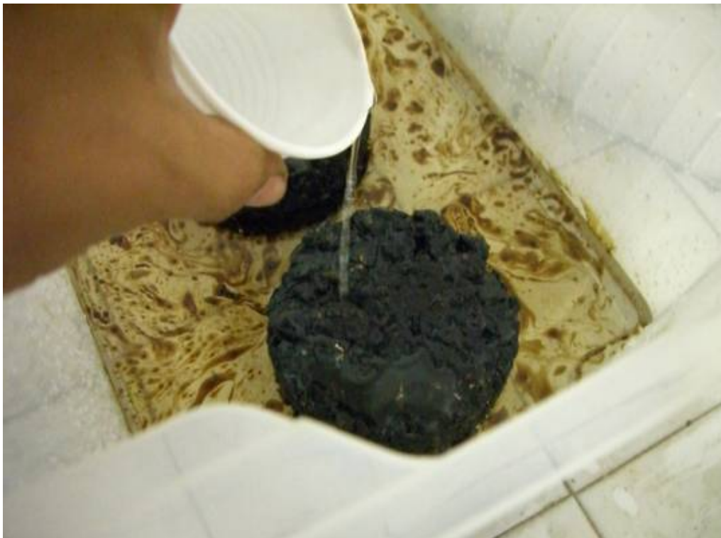
Figura III-30. Ensayo de semi-inmersión de probetas de mezcla bituminosa porosa en agua con hidrocarburos.
