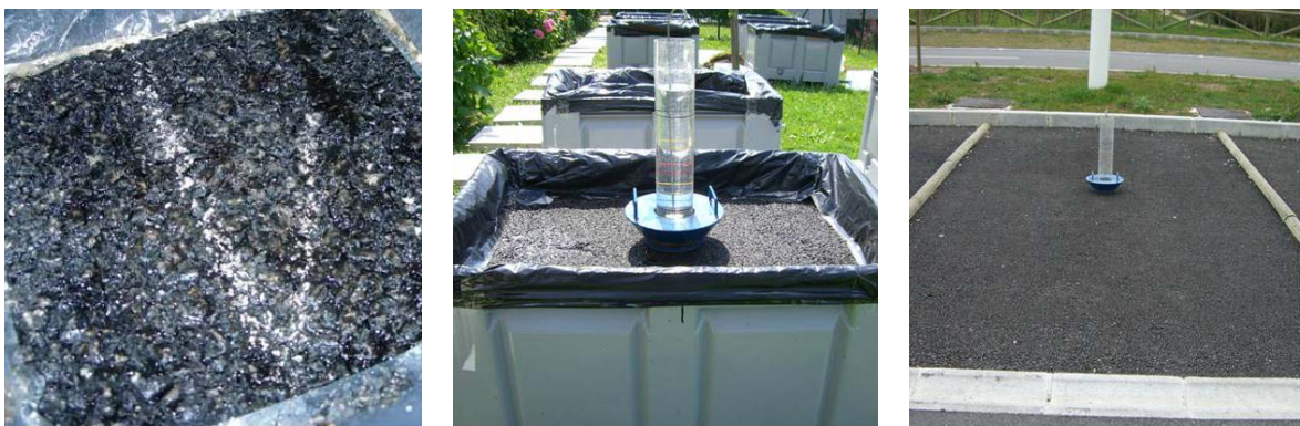
Figura III-33. Mezcla bituminosa empleada en la construcción de los modelos de firmes permeales del Laboratorio, del Campus y de Gijón.
