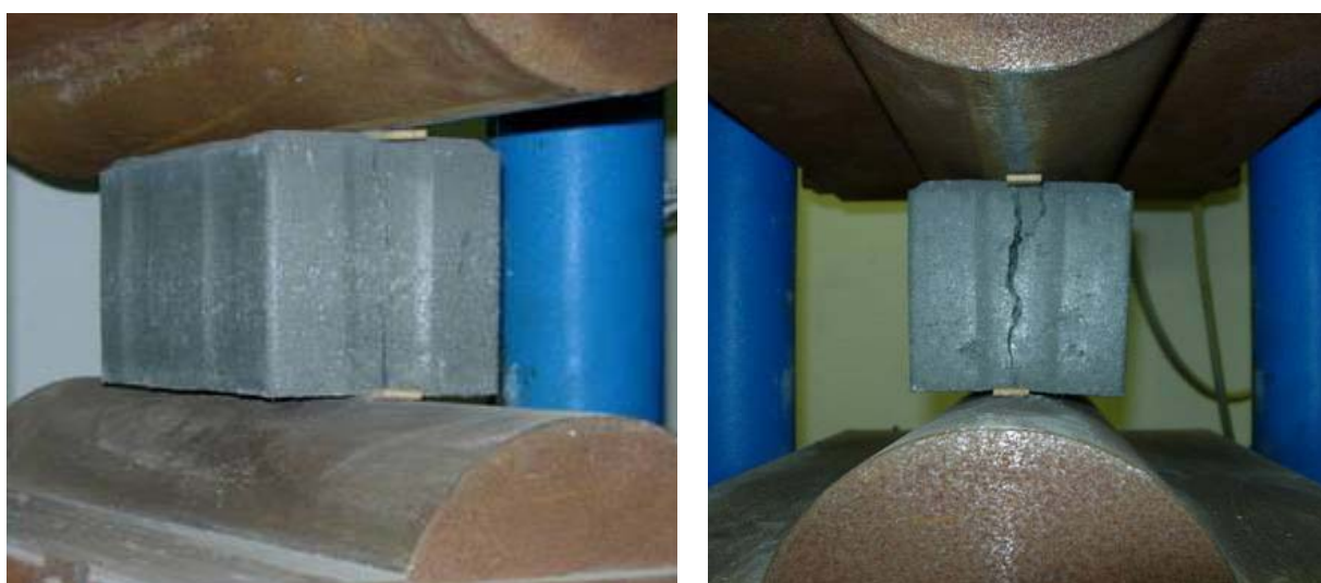
Figura III-7. Ensayo de resistencia a la rotura de los adoquines (UNE-EN 1338, 2004).
