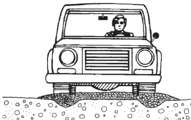
Fig. 12 Reparación importante con aportación de material para el firme
