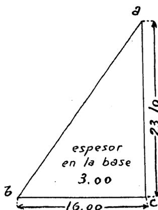
que pudiéramos llamar «pantalla» y un contrafuerte. Para su estudio tomamos como eje de las  $x$  el de la sección base del contrafuerte, y de las  $y$  el vertical que pasa por la intersección de aquél con el paramento virtual de la «pantalla» (que es vertical), fijando como sentidos positivos el de aguas arriba para el primero y el de abajo hacia arriba para el segundo.
