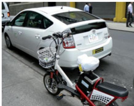
Las BATERÍAS actuales son de Litio, de 24 V o de 36 V. Su duración depende evidentemente de su uso, normalmente es de más de 30 km. La batería es el único elemento cuyo peso y volumen distinguen a una bici normal de una eléctrica, pues los demás elementos, incluso el motor, resultan casi imperceptibles.
