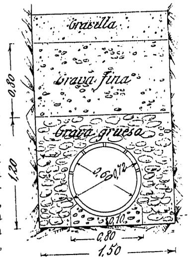
Fig. 2.ª Sección de la galería filtrante, según proyecto.
