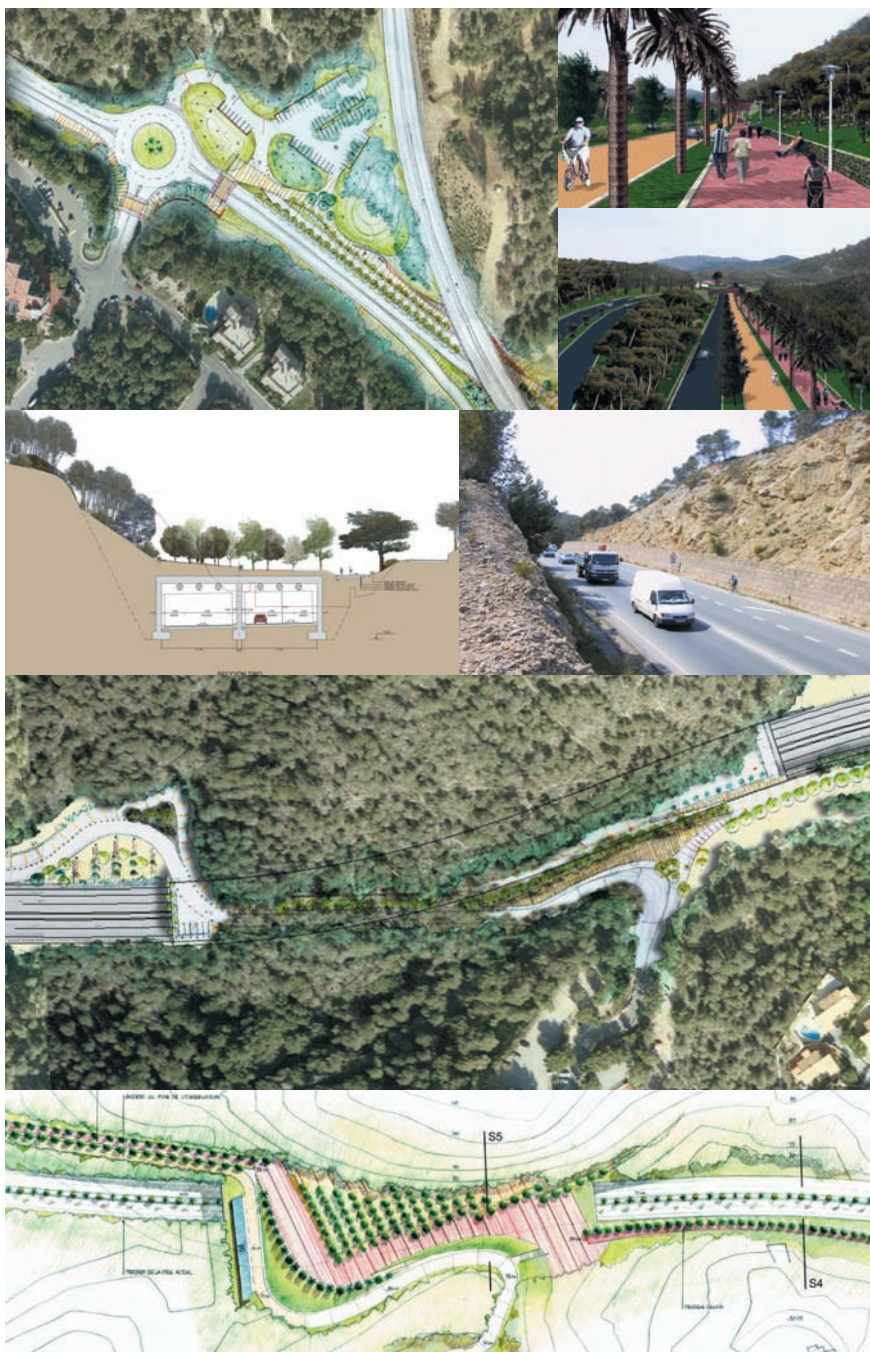
Accesos y Enlace Este de Peguera. Sección propuesta para el paso del Coll d'en Gorvió y foto del estado actual. Fotomontaje de la situación propuesta. Continuidad de la zona boscosa
