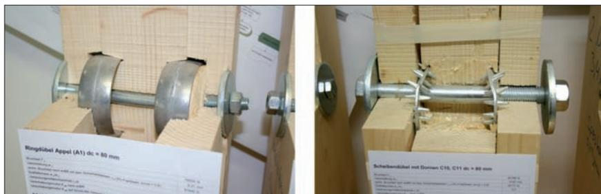
Figura 5.27 Pruebas de resistencia al corte de conectores de anillo y dentados. Ensayos realizados en el Instituto de la madera para la construcción de la Universidad Técnica de Graz.
