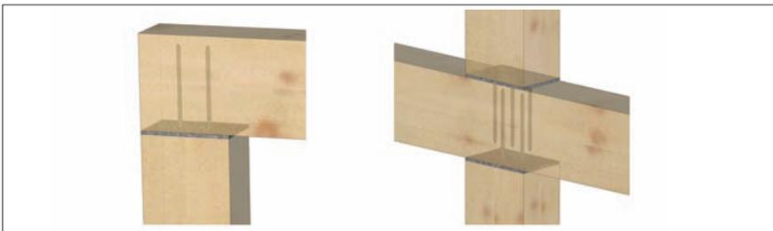
Figura 5.12 Uso de los conectores de doble rosca para refuerzo de zonas de compresión perpendicular.
