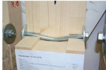
Fallo de la clavija y de la madera por aplastamiento en doble cortadura.
