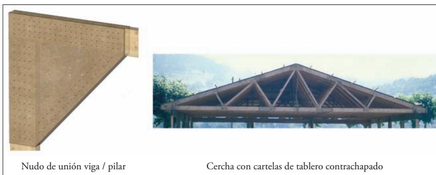
Figura 5.2 . *Ejemplos de uniones clavadas con tableros contrachapados.*
