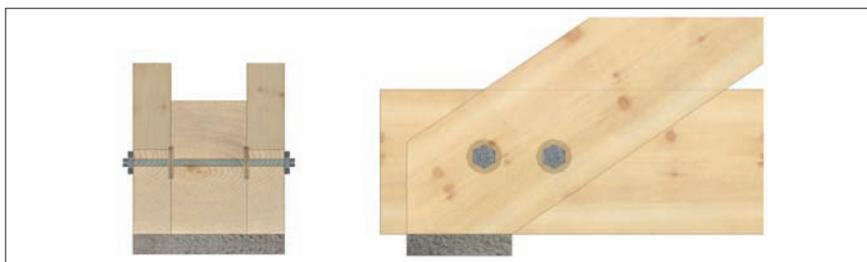
Figura 5.17 Apoyo de cercha realizado con conectores de superficie fijados con pernos.
