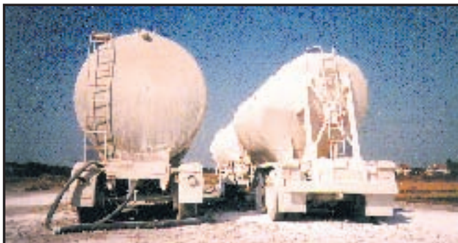
Fig. 7 - Transporte y almacenamiento de la cal.
