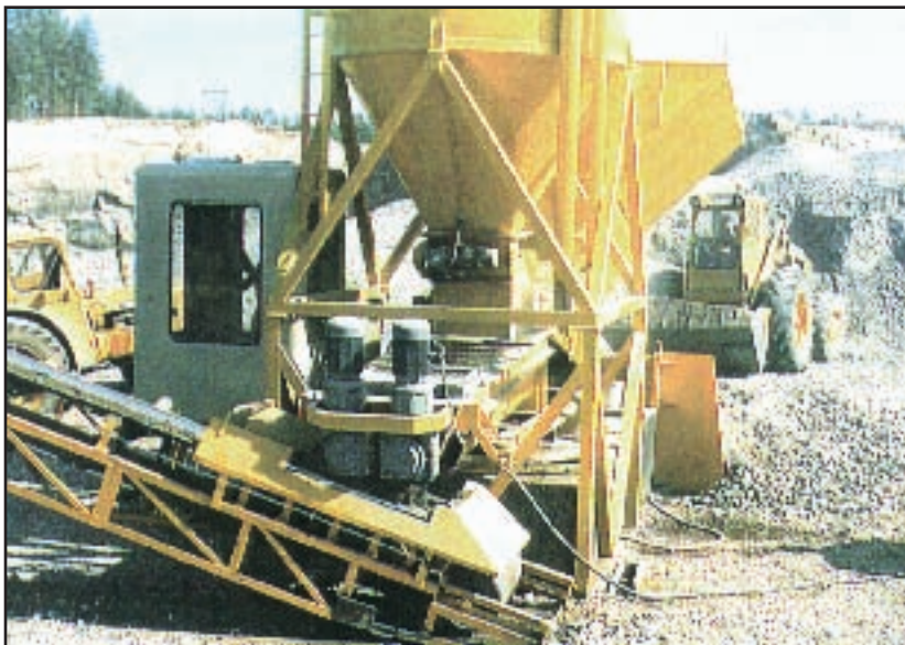
Fig. 18. Central mezcladora de arcilla de doble eje.(Belmix)
