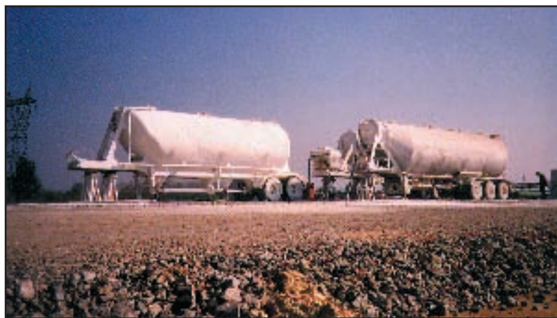
Fig. 11. Almacenamiento de la cal.
