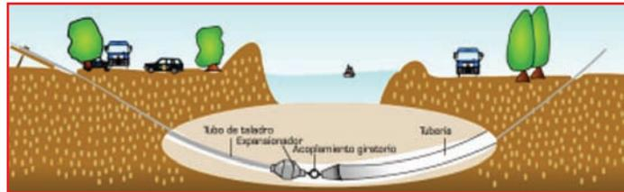
Finalmente, alcanzado el diámetro requerido en el microtúnel, se engancha la tubería definitiva al varillaje y se arrastra hacia la perforadora.
