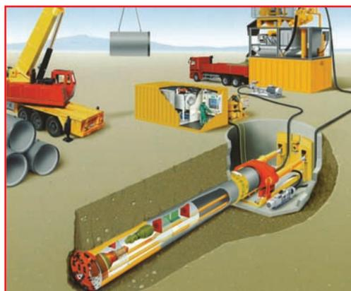
Desde el pozo de ataque se suministrará la presión necesaria a la cabeza de corte para que pueda progresar. Para ello se utilizarán una serie de gatos hidráulicos apoyados en el muro de reacción a través de la placa de empuje.
