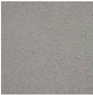
7. Acabado raspado o labrado.
