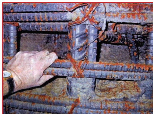
Fig. 20. Falta de penetración del hormigón a través del armado existente. (Brown, D. A., 2004).
