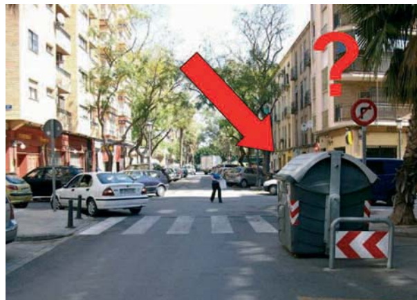
Elementos del mobiliario urbano que impiden la visibilidad en pasos de peatones.
