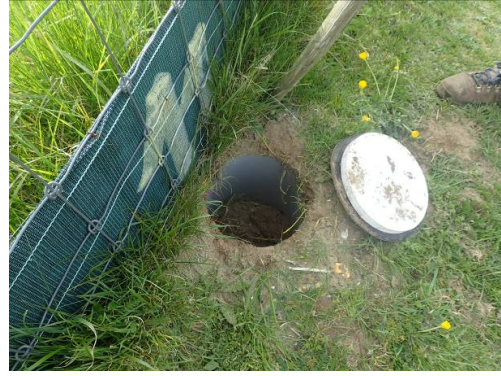
Photo 18 : Exemple d'amélioration d'un seau avec l'existence d'une section de tube PVC ouvert directement sur le sol nu et muni d'un couvercle lorsque il s'agit d'interrompre la capture sur la RD 940 - (dunes de Slack) (Source : © A. Morand, Cerema Est)
