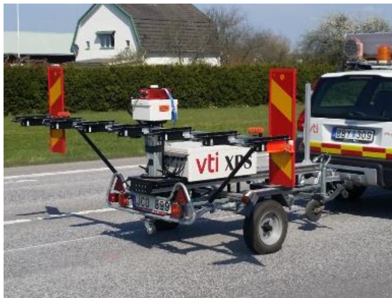
Figura 6.5-1 – Sistema de referencia para la medida del perfil transversal medio y de la pendiente transversal.
