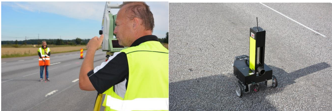
Figura 6.5-3 – Estación Total empleada para adquirir perfiles cada 10-m (izquierda) y el remolque robotizado primal utilizado como referencia del perfil longitudinal (derecha)
