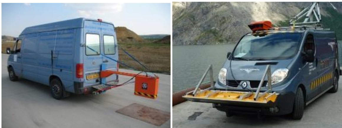
Figura 4.2-1 – Sistema GPR con una sola antena para mediciones A velocidad de tráfico (izquierda) y sistema GPR con múltiples antenas para mediciones 3D (derecha, [2])
