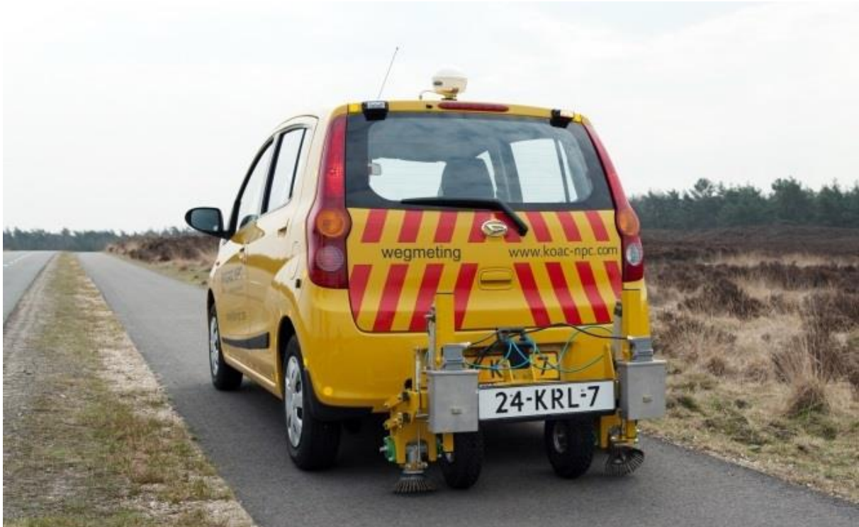
Figura 1.2-2 – Medidor de confort para bicicletas [fuente: KIWA, Países Bajos]
