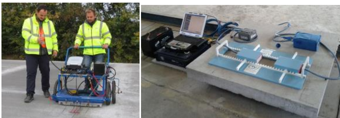
Figura 4.2-2 – Sistema GPR para mediciones a velocidad de marcha (izquierda) y medición local GPR con diferentes posiciones de antena transmisora y receptora (derecha)
