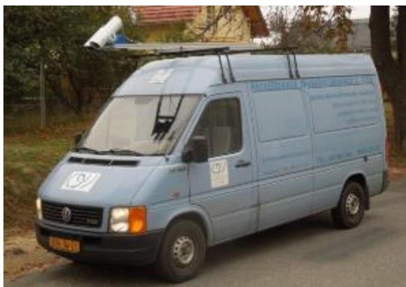
Figura 3.2-1 – Vehículo de medida con cámara térmica fijada a un soporte de techo (izquierda) y cámara térmica con detector de enfriamiento (derecha)
