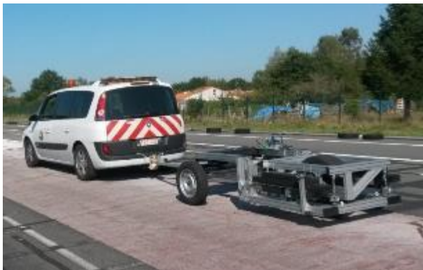
Figura 2.2-2 – Remolque para el método de la fuerza
