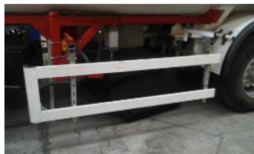
Figura 2.3-4 - Sistema de medida completo instalado en el lado izquierdo del remolque cisterna entre los dos ejes
