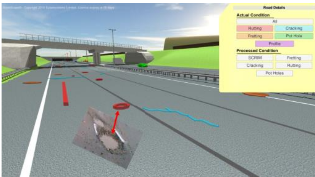
Figura 3.1-3 - 'Assetscape' – Imágenes empleadas para incluir defectos en un modelo 3D
