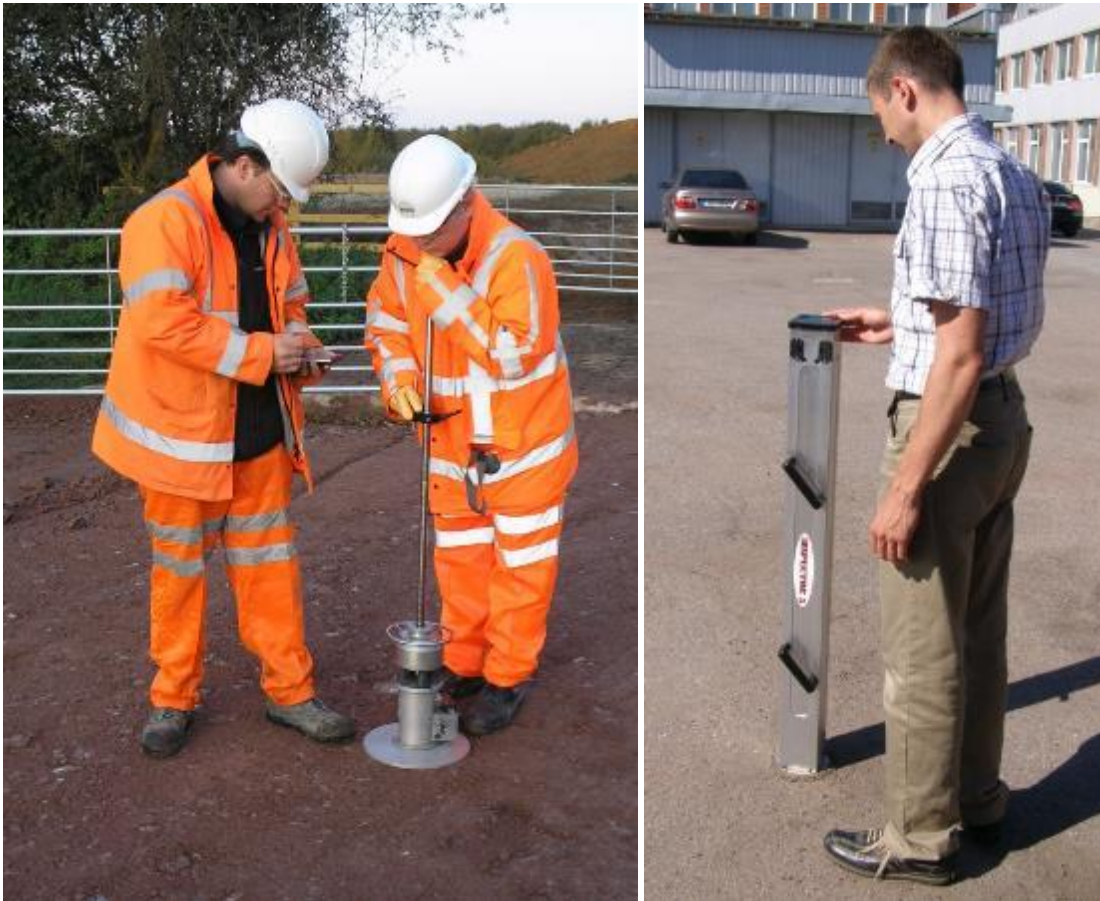
Figura 4.3-1 – Ensayos de rutina con LWD en el Reino Unido (fuente: AECOM) (izquierda), Equipo lwd de “Inspector Englo” (fuente: Englo) (derecha)
