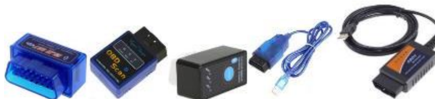
Figura 5-2 – algunos ejemplos de conectores BUS-CAN
