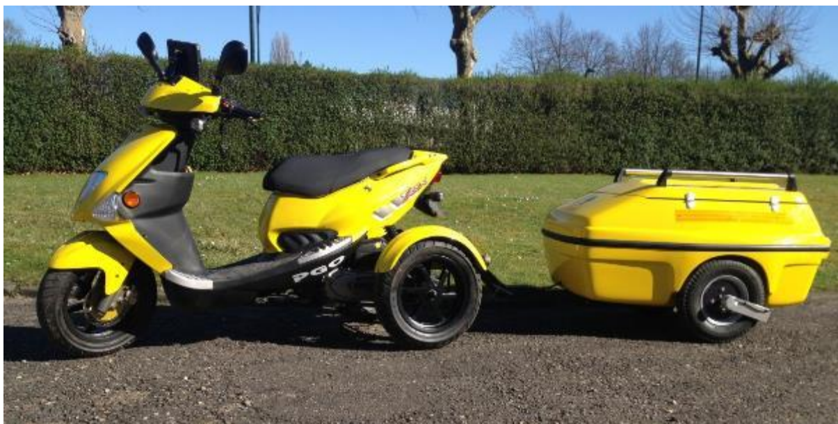
Figura 1.2-1 - Perfilómetro para carriles bici montado en un remolque [Fuente: Agencia de carreteras y tráfico, región de Bélgica/Flandres]
