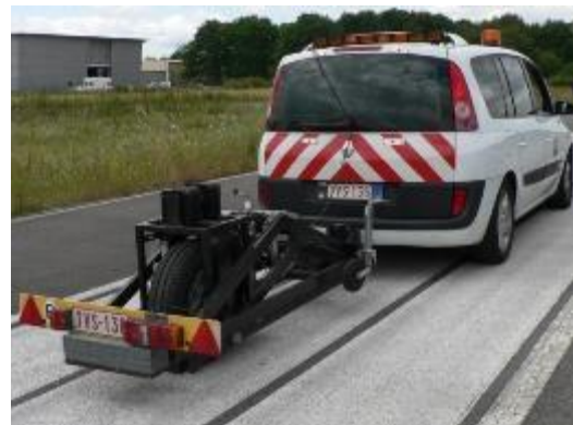
Figura 2.2-3 – Remolque para el método del ángulo sin parabrisas
