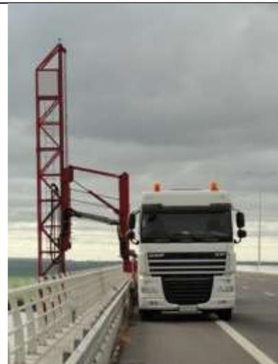
Iluminación en la mediana que permite el uso del vehículo de inspección bajo el puente.
