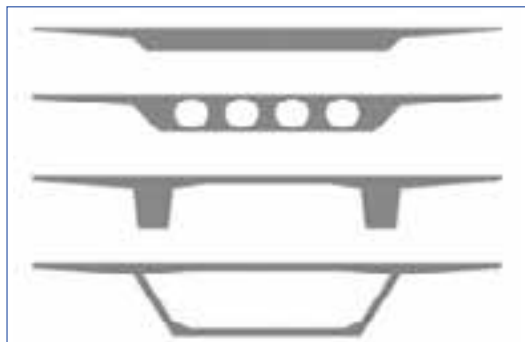
Figura 2. Tipos de sección transversal óptimos para uso de cimbras autolanzables.
