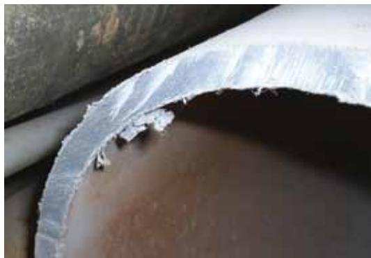
Figura 9. Ejemplo de material friable: tubería de agua
